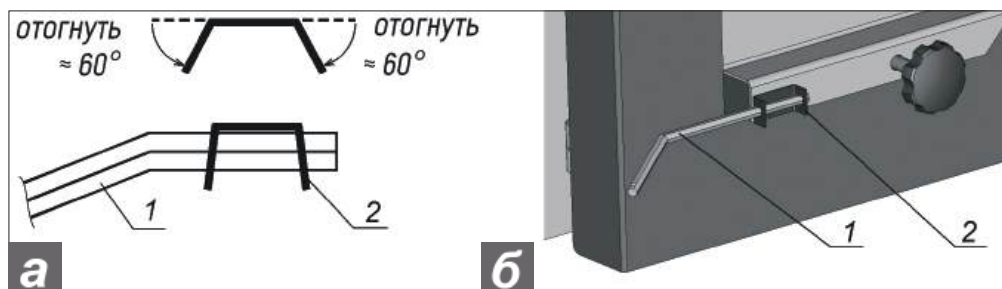
Рисунок 2. Схема гибки пластинки (а) и установка (б) шестигранного стержня: 1 – стержень для крепления цепи регулятора тяги; 2 – пластинка.
